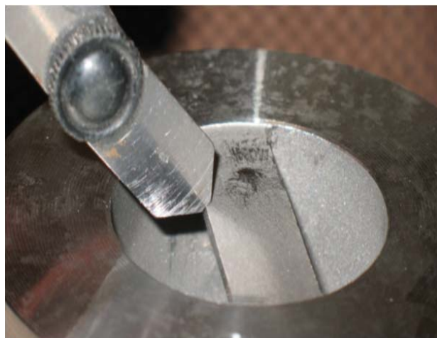
Рис.3: Проверка округления кромок вихревого расходомера Prowirl. Радиус закругления гораздо меньше 1 мм, что может быть проверено с помощью соответствующего калибра.
